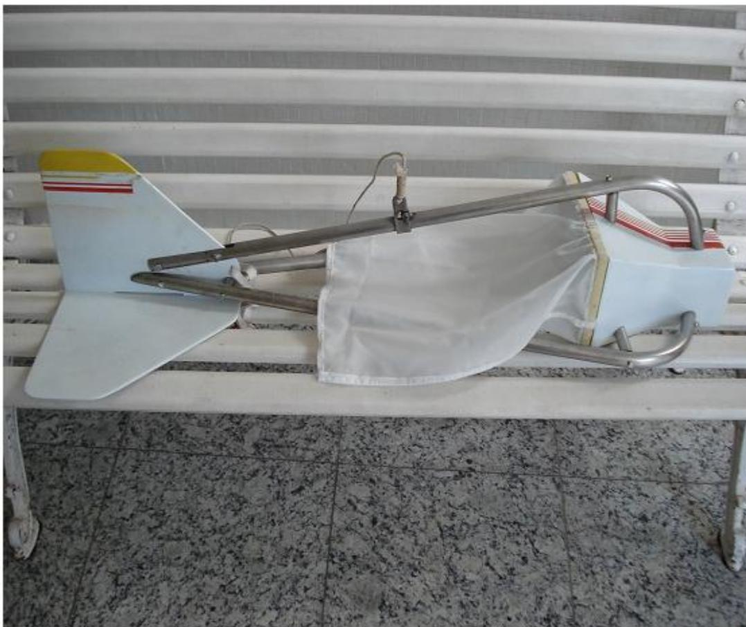
**Figura 14:** Equipamento amostrador de carga de fundo, do tipo Helley-Smith.
