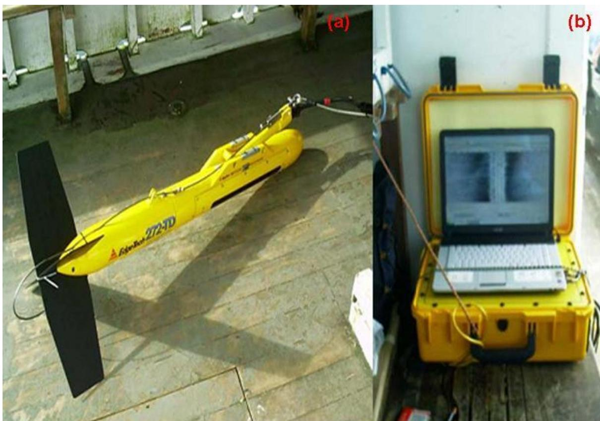
**Figura 17:** (a) Transdutor ou peixe 272TD, emissor e receptor do pulso sonoro; (b) processador (caixa amarela) conectado a um laptop com o software de aquisição dos dados *Discover 4100* instalado.
